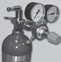
Adaptador de carga de oxígeno y/o acople para válvula de reducción medicinal, entrada Yoke 870, salida rosca (mano derecha 21.7 mm, 14 filetes / pulgada), construido en bronce cromado sanitario de excelente calidad de exportación (producto de servicio pesado continuo).
