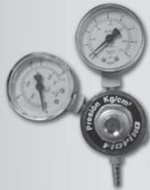
Válvula de reducción medicinal, de 2 manómetros, 1 de alta (escala 0-315 Kg/cm2) y 1 de baja (escala 0-16 Kg/cm2), Salida, presión controlada/regulada a necesidad en kg/cm2 (mide presión restante en el tubo y presión de salida).
